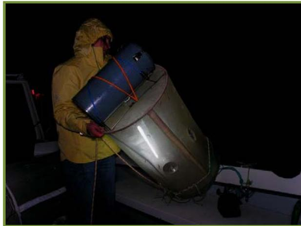
Figura 9. Colocação de uma armadilha de luz para captura de larvas de peixes no Parque Marinho da Arrábida.
