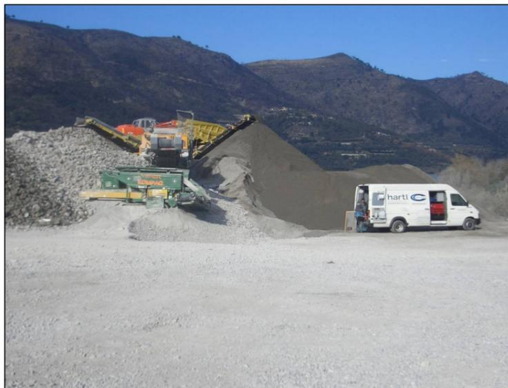
Le operazioni di lavorazione degli inerti prelevati nel Fiume Roia, con l'impiego di impianto di vibrovagliatura e frantumazione
