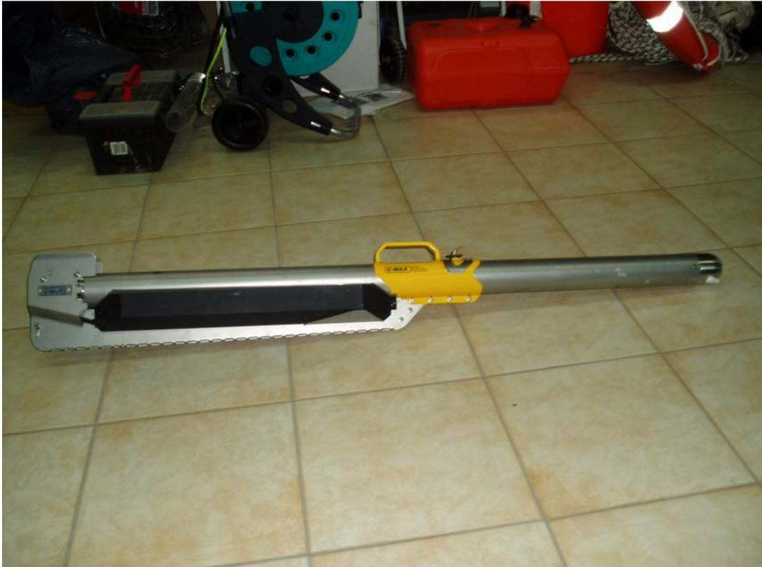
Figure 5. Le sonar de balayage latéral (side scan sonar) C-Max CM2 utilisé pour la caractérisation des sédiments du fond.
